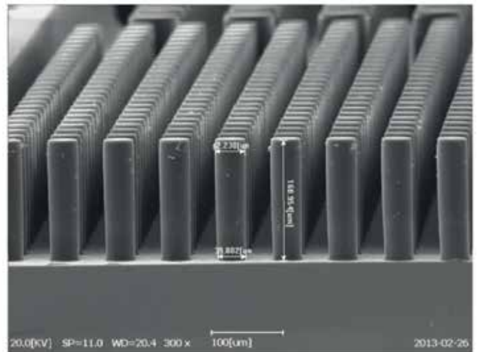
SU-8 height 170µm width 40µm
